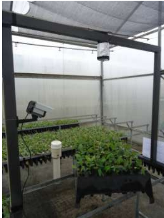
Figura 2. Suporte utilizado para fixação da célula de carga
