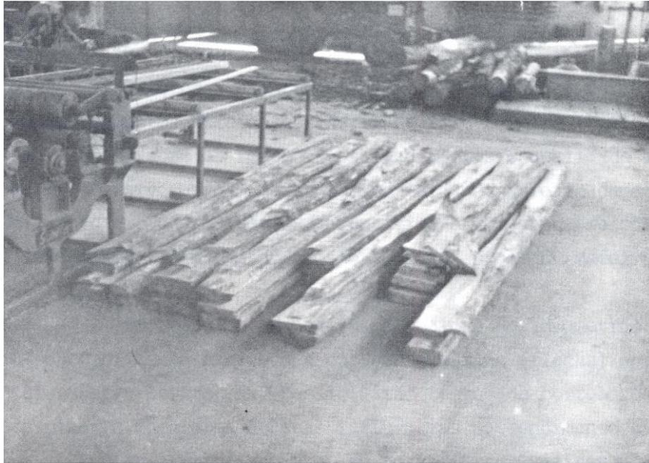
**FIGURA 6** - Serra Circular Múltipla (Canteadeira), utilizando na resserragem de tábuas e pranchões.
