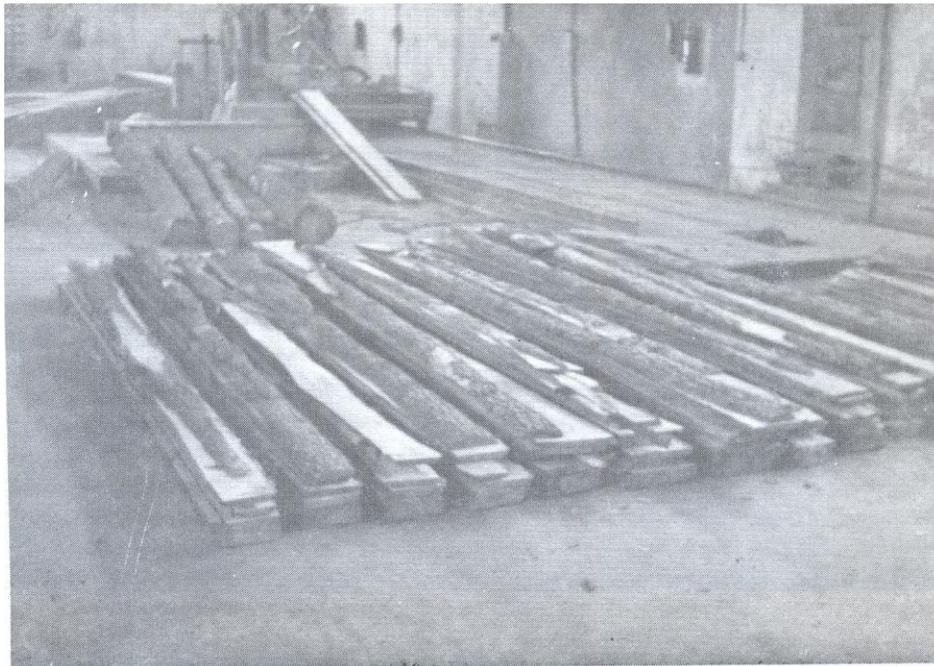
**FIGURA 3** - Peças obtidas através do desdobramento de toras de *Pinus* na Serra de Fita. Detalhe da espessura das peças e perdas no esquadrejamento.
