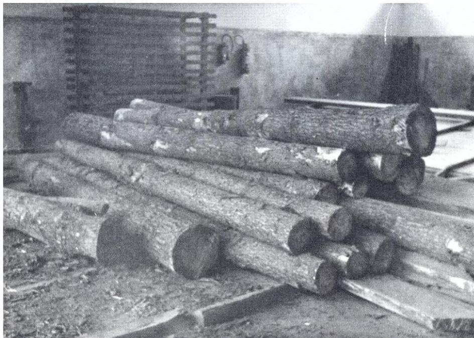
**FIGURA 1** - Aspecto dos variados diâmetros das toras de *Pinus*, antes do seu processamento.
