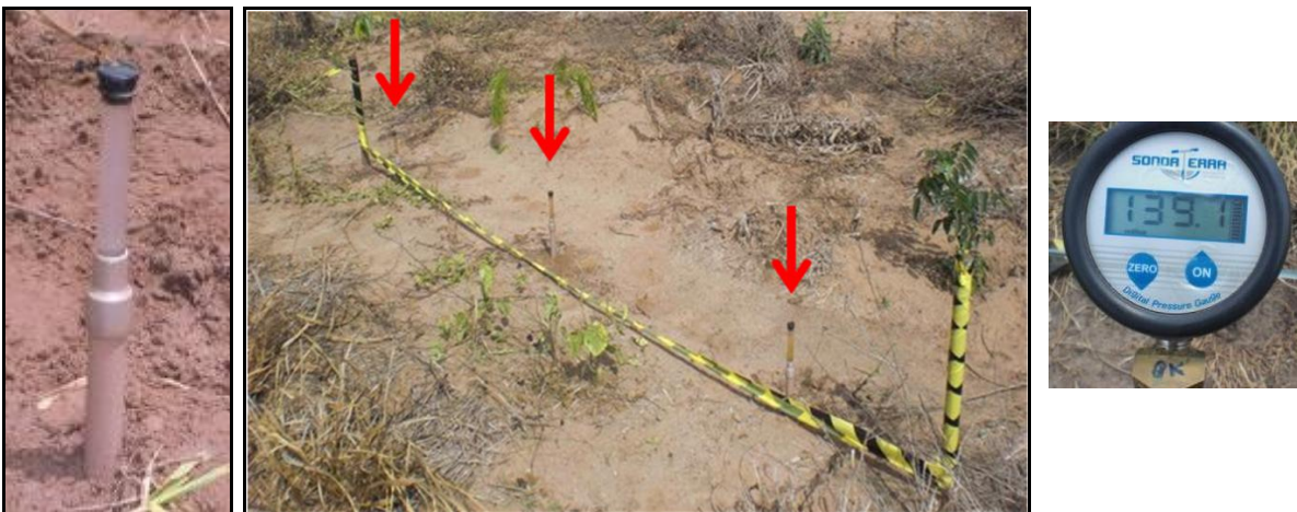
Figura 11: Tensiômetro instalado no solo. Conjunto de tensiômetros em cada profundidade (20, 40 e 60 cm, respectivamente) e manômetro digital que obtém a leitura do potencial matricial de água no solo.
