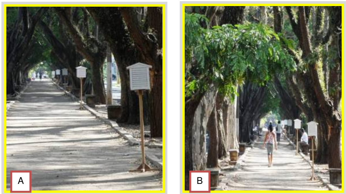
Figura 13 - Exemplo dos abrigos meteorológicos contendo em cada um registrador ThermoData, dispostos a cada 40m na direção Leste (A) – Oeste (B) na Av. da Saudade
