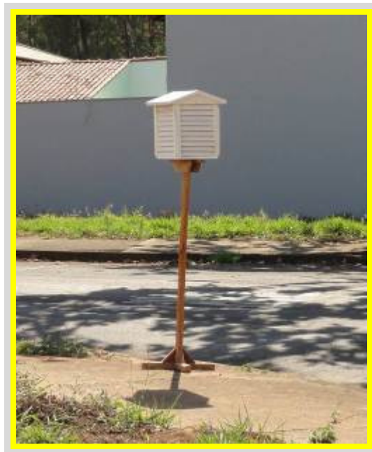
Figura 8 - Abrigo meteorológico confeccionado de madeira tipo veneziana, pintado de branco com pé de 1,5m a partir do solo
