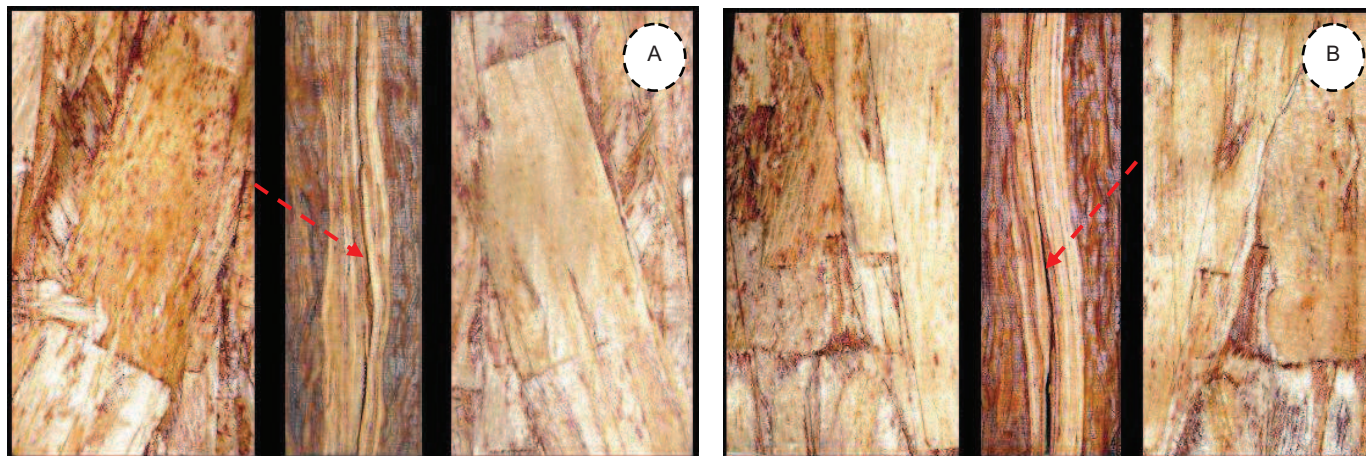
Figura 34 - Ensaio de ligação interna dos painéis OSB de partículas de tora integral (A) e de rolo resto (B) do lenho do tronco de árvores de Pinus taeda – falhas detectadas na região do miolo
