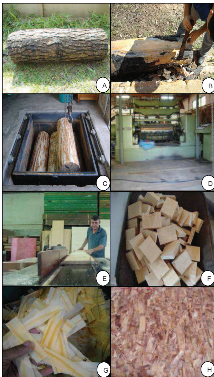
Figura 12 - Manufatura do painel OSB. Tora de pinus (A) e procedimento de descascamento (B); pré-aquecimento das toras de pinus (C) e sua laminação (D); obtenção das tábuas de pinus (E); blocos e partículas de pinus (F,G); painel OSB de partículas de madeira de pinus (H)
