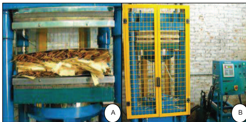
Figura 18 - Colchão de partículas de madeira de pinus nos pratos da prensa (A) e a prensa hidráulica tipo Marconi (B)
