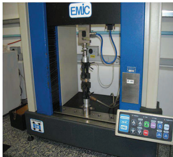
Figura 15 - Máquina de ensaio de tração de papel e celulose utilizada para os ensaios de partículas
