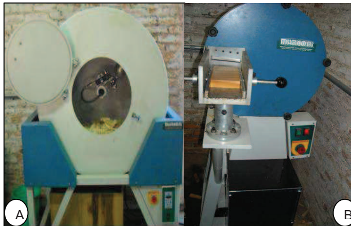
Figura 16 – Equipamentos encoladeira (A) e gerador de partículas de madeira tipo Marconi (B)
