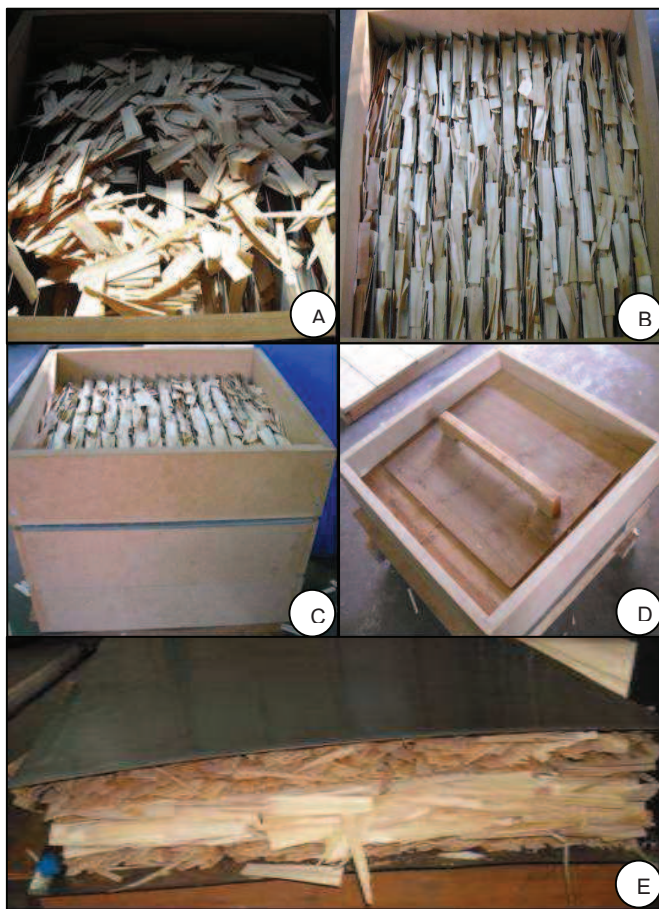
Figura 17 - Partículas de madeira de pinus sem (A) e com orientação (B), partículas de madeira orientadas (C), caixa formadora (D) colchão de partículas prensado manualmente (E)
