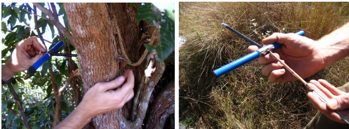
Figura 2.1 – Utilização do trado na extração de baguetas do tronco das espécies amostradas, para análise química e de densidade da madeira.
