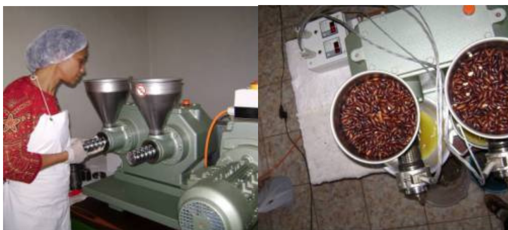
FIGURA 4.6 – Extratora de óleo vegetal das sementes de baru
