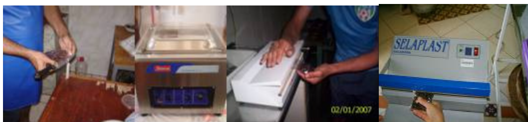
FIGURA 5.6. – Técnicas e tecnologias utilizadas para fechamento das embalagens.
