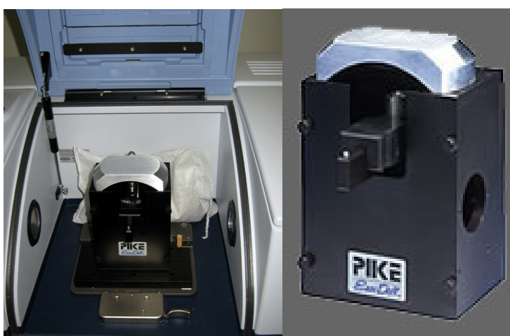
Figura 4.4 – Dispositivo de reflectância difusa modelo EasyDiff da marca Pike.
