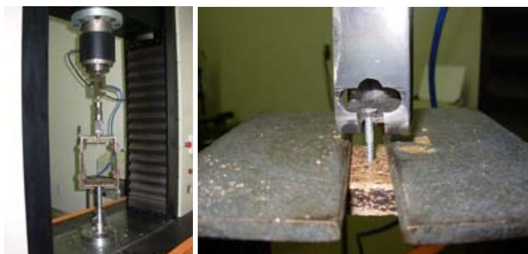
Figura 3.15 - Ensaio de arrancamento de parafuso.
