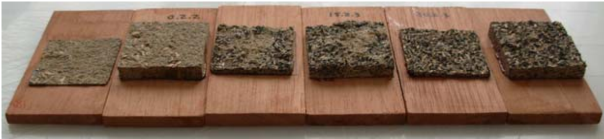
Figura 4.28 - Aparência dos corpos-de-prova de compósitos cimento-madeira-borracha após o ensaio de ligação interna.
