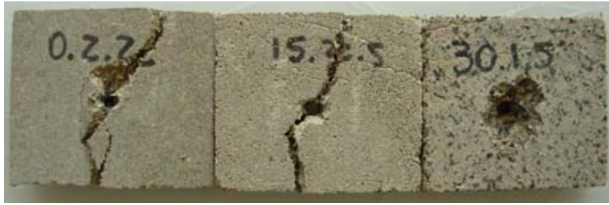
Figura 4.30 - Aparência dos corpos-de-prova de compósitos cimento-madeira-borracha após o ensaio de arrancamento de parafuso.
