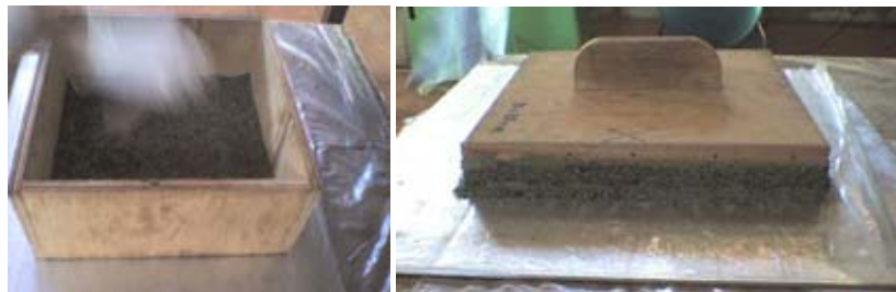
Figura 3.10 - Formação do colchão cimento-madeira-borracha.
