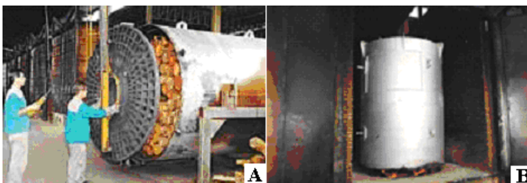
Figura 4.12. Forno cilíndrico metálico (Bricarbrás). (A) Vista da grelha metálica. (B) O cilindro com lenha no forno de carbonização (BRICARBRÁS, 2006).
