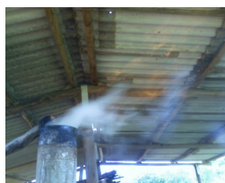
Figura 9.2. Queima dos gases produzidos durante a carbonização dos destopos de eucalipto.
