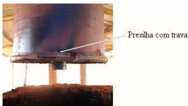
Figura 6.4. Detalhe da presilha com trava que fecha a grelha ao tonel.
