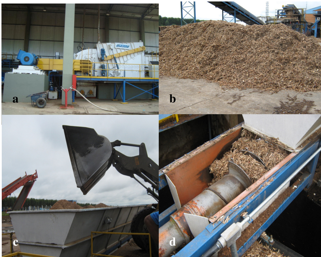
Figura 4 – Etapas da dosagem do cavaco reciclado na linha de produção. a) Triturador do reciclado; b) Cavaco do reciclado; c) Alimentação do cavaco; d) Rosca dosando o cavaco de reciclado.
