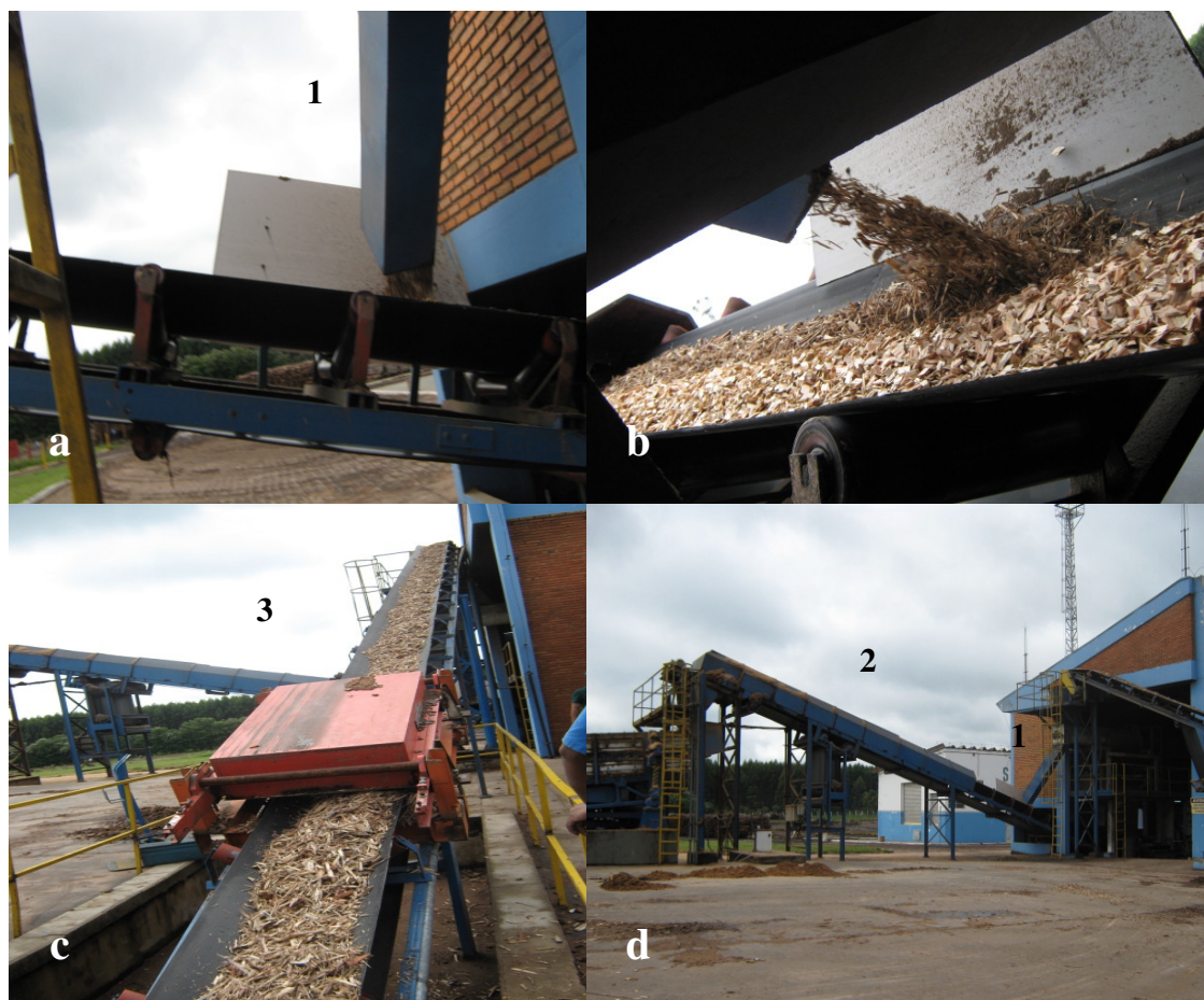
Figura 5 – Etapas da dosagem do cavaco de reciclado na linha de produção (cont.): a e b) Alimentação do cavaco de reciclado na esteira de saída do picador; c) Cavaco de reciclado na esteira após a dosagem; d) Esteira de alimentação (1), encontro das esteiras de ambos os cavacos (2) e a peneira (3).
