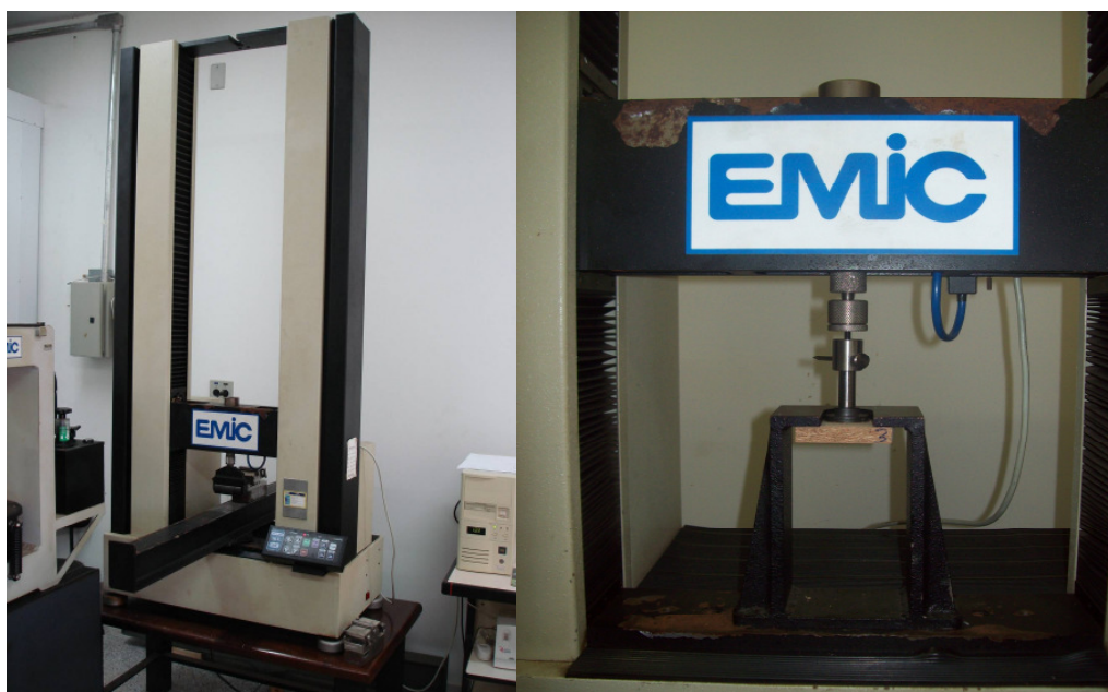
Figura 11 – Máquina universal de ensaios EMIC-DL 10000 utilizada na realização dos ensaios mecânicos dos corpos-de-prova das faixas 2 e 4. a) vista geral do equipamento; b) detalhe da realização de ensaio
