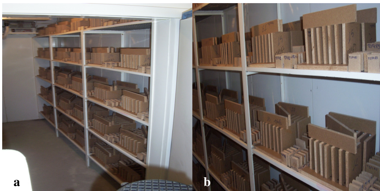
Figura 10 – Disposição dos corpos-de-prova das faixas 2 e 4 na câmara climática do Laboratório da Madeira – FCA – UNESP – Botucatu/SP.
