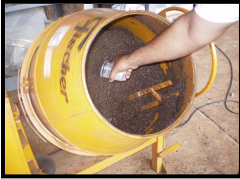
Figura 4. Homogeneização de substrato Carolina Soil do Brasil® e Yorim Master S®. em betoneira.
