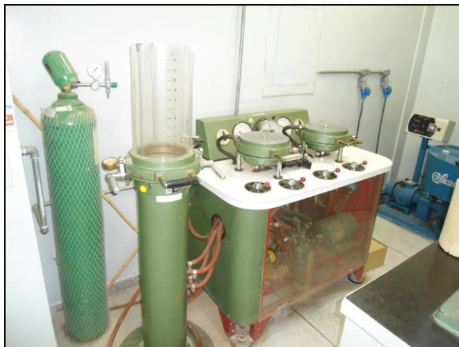
Figura 6- Aparelho formador de folhas tipo Köthen rapid. REGMED-F/SS-2
