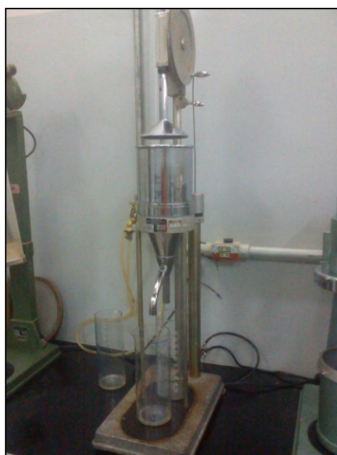
Figura 5- Equipamento para determinação do grau de refino (Schopper Riegler - °SR). REGMED-SR-A
