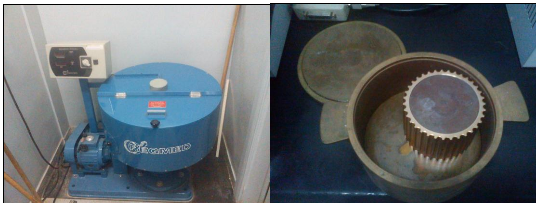
Figura 4- Moinho centrífugo Jokro Mühle. REGEMED-MJ/K6
