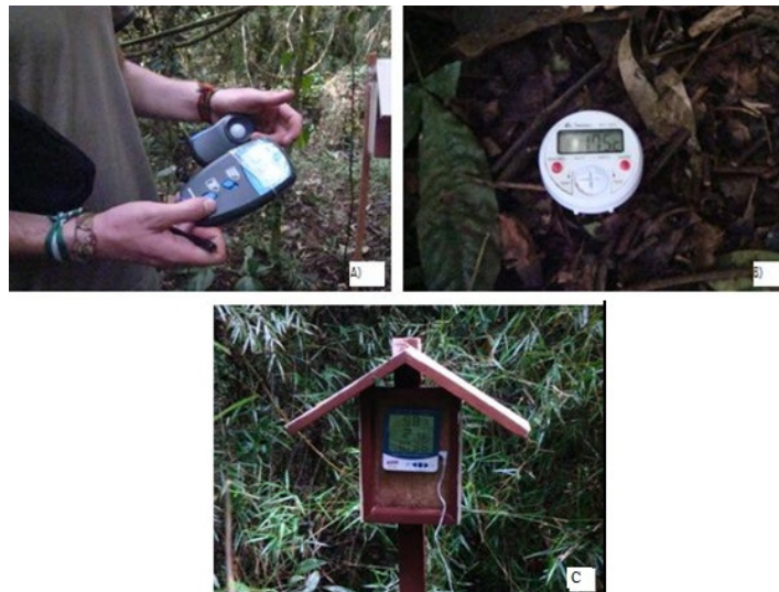
Figura 10 - Equipamentos utilizados na medição do microclima : a) luxímetro digital (intensidade luminosa); b) termômetro de solo (temperatura do solo); c) termohigrômetro digital (temperatura e umidade do ar), protegido por uma caixa com telhado de madeira.
