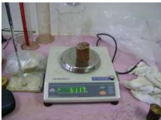
Figura 3: Determinação da massa seca da amostra de madeira (A), determinação da massa imersa em água (volume) (B).
