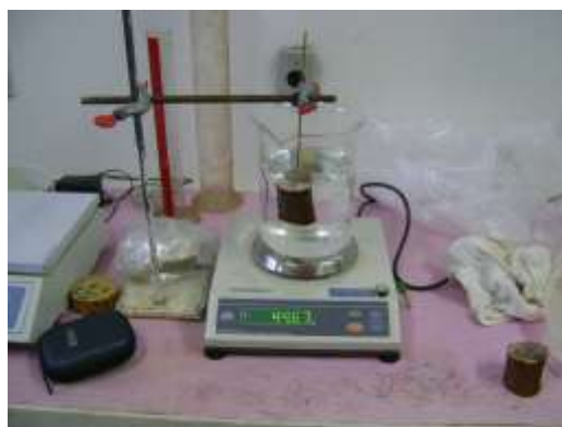
Figura 3: Determinação da massa seca da amostra de madeira (A), determinação da massa imersa em água (volume) (B).
