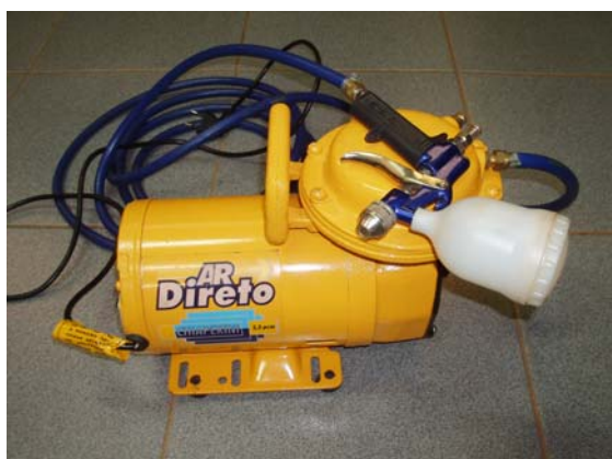
Figura 16. Compressor de ar.
