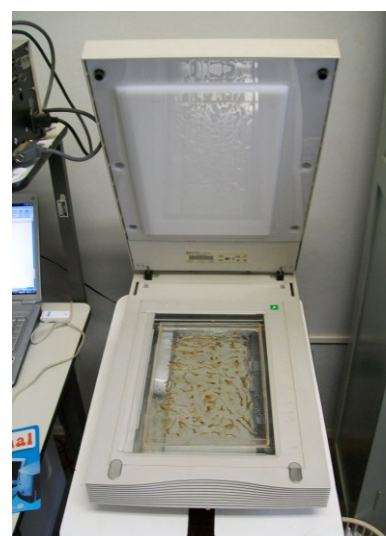
Figura 16. scanner de raízes utilizado no trabalho.
