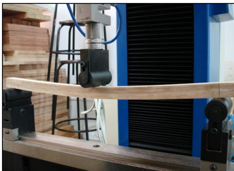
Figura 11. Ensaio de flexão estática. Corpos de prova de 20 mm x 20 mm x 460 mm (vão livre de 420 mm) durante o ensaio
