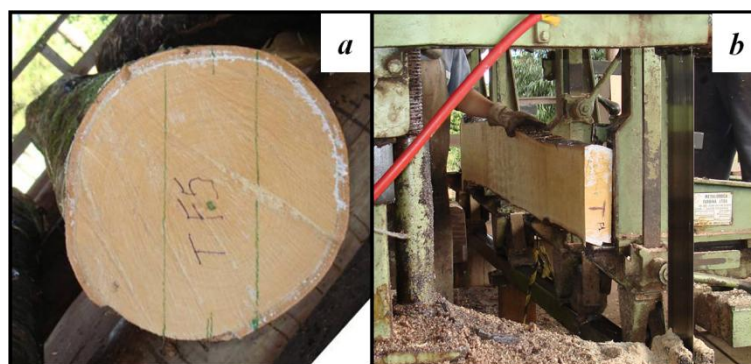
Figura 3. (a) - Linhas de corte na seção transversal no topo da tora; (b) - desdobro da tora em pranchão contendo a medula da árvore
