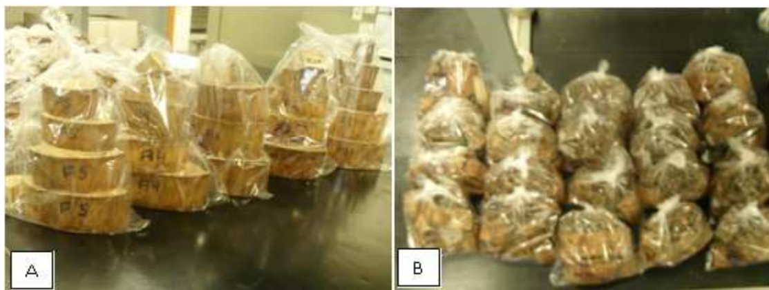
Figura 4. Material utilizado para determinação da densidade básica. a) cunha da madeira sem casca; b) casca da madeira
