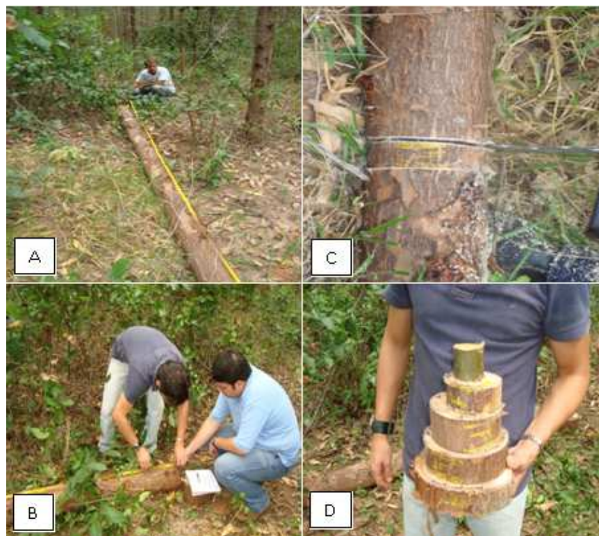
Figura 3. Coleta do material para pesquisa. a) medição da altura total e comercial; b) cálculo e demarcação dos discos a serem retirados; c) corte dos discos com 5 cm de espessura; d) amostra representativa da árvore
