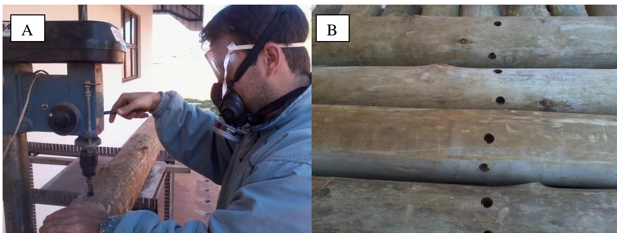
Figura 8. Retirada das baguetas amostrais para análise de retenção dos mourões: A – indica a perfuração da broca; B – indica as peças já perfuradas na porção central dos mourões.
