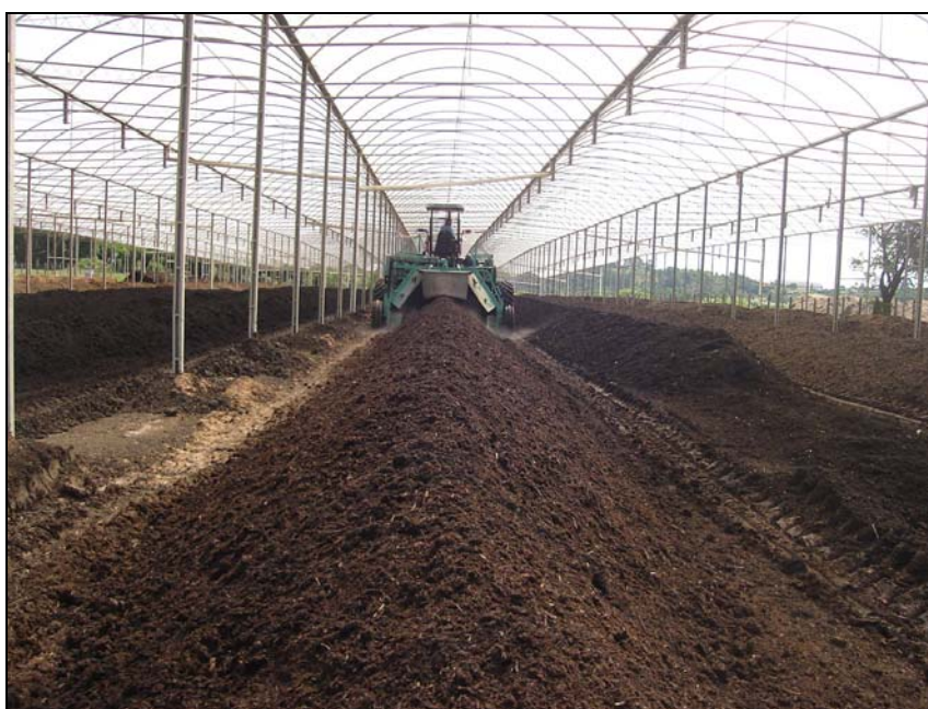
Figura 6: Leira com formação do composto de bagaço-de-cana, poda de árvores e lodo de esgoto na Companhia Saneamento de Jundiaí.
