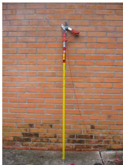
Figura 8. Equipamento (tesoura e haste) usado nas operações de colheita de sementes. Foto: Paulo Eduardo T. dos Santos.
