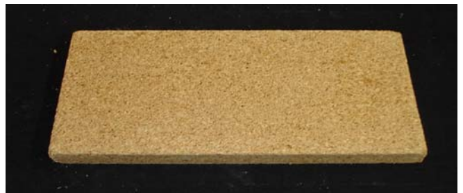
Fig. 3. Painel de aglomerado com dimensões 150 mm x 100 mm x 15 mm.
