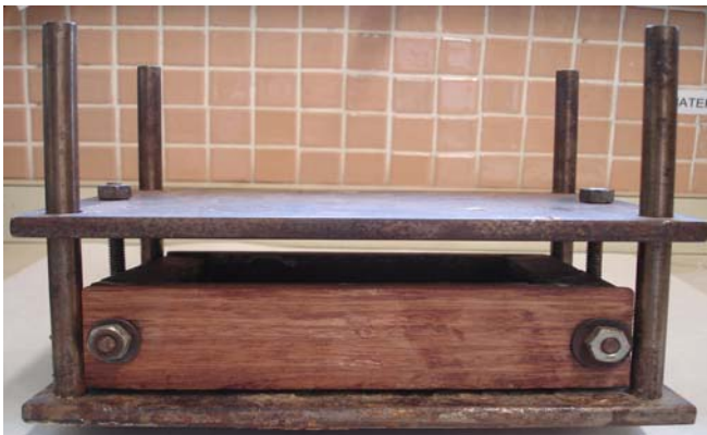
Fig. 2. Molde em aço e madeira para prensagem dos painéis de aglomerado.
