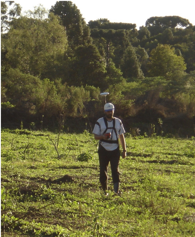
Figura 3. Rastreio pelo método cinemático.
