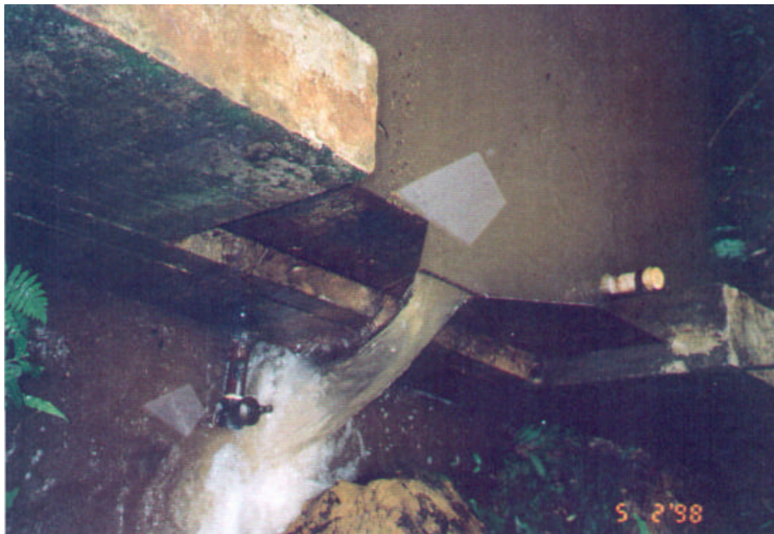
Figura 3 - Vista do vertedor misto instalado na Microbacia Experimental da Lage.
