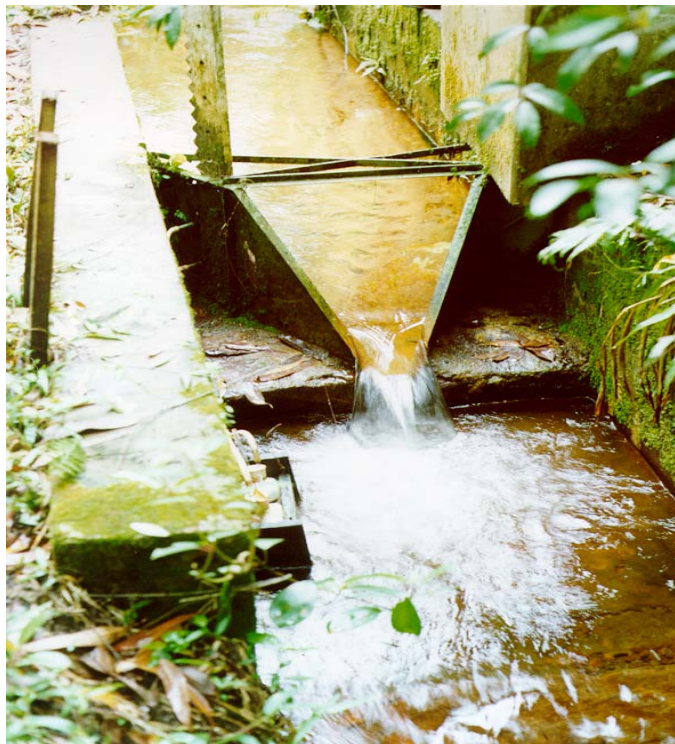
Figura 3 – Calha do Tipo “H” da microbacia experimental do Tinga
