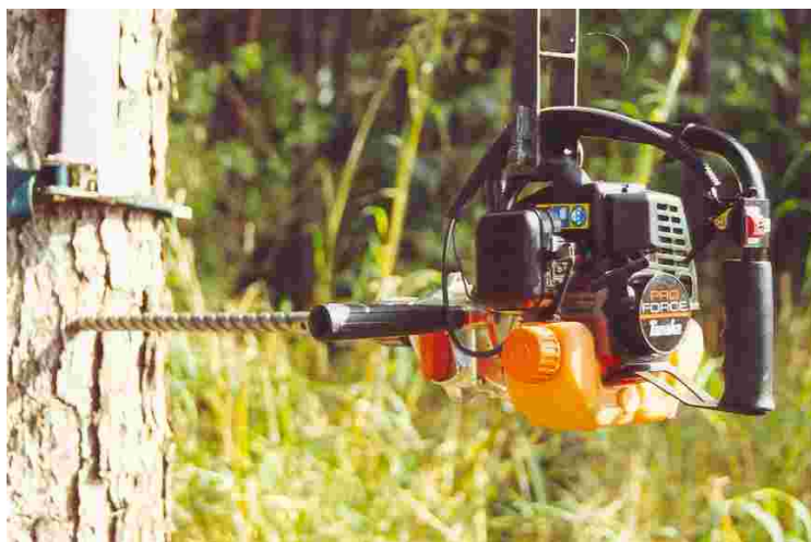
Figura 5 – Extrator motorizado e sonda metálica utilizada na coleta de amostras do lenho das árvores de A. columnaris .
