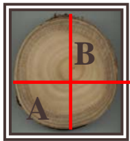
Figura 6 - Amostragem de discos para densidade básica
