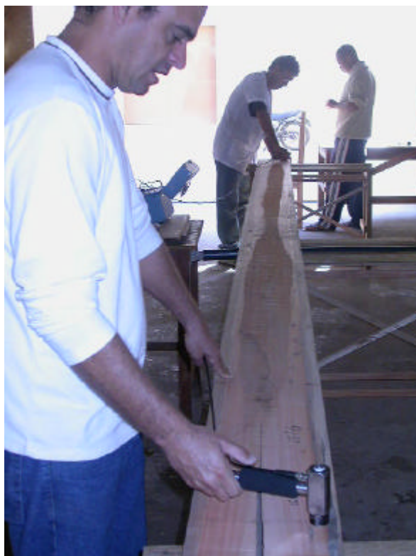
Figura 11 – Determinação do módulo de elasticidade pela velocidade de propagação de ondas de tensão.
