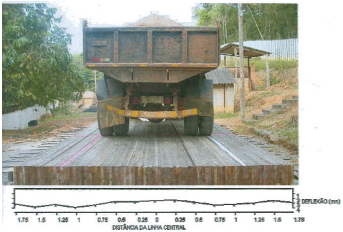
Figura 36 – Deflexão transversal do tabuleiro, quando carregado, medida em 15 pontos, em mm.
