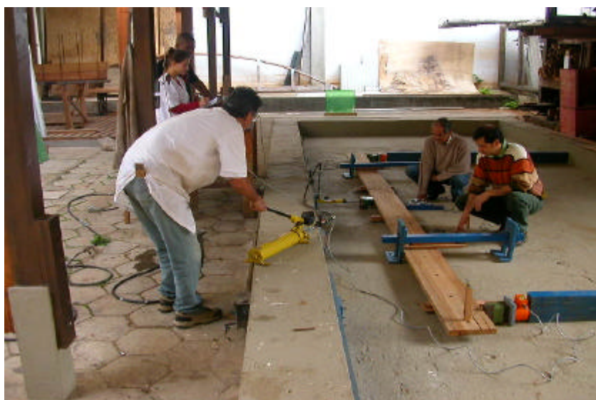
Figura 10 – Ensaio de flexão estática das tábuas para determinação de seu módulo da elasticidade.
