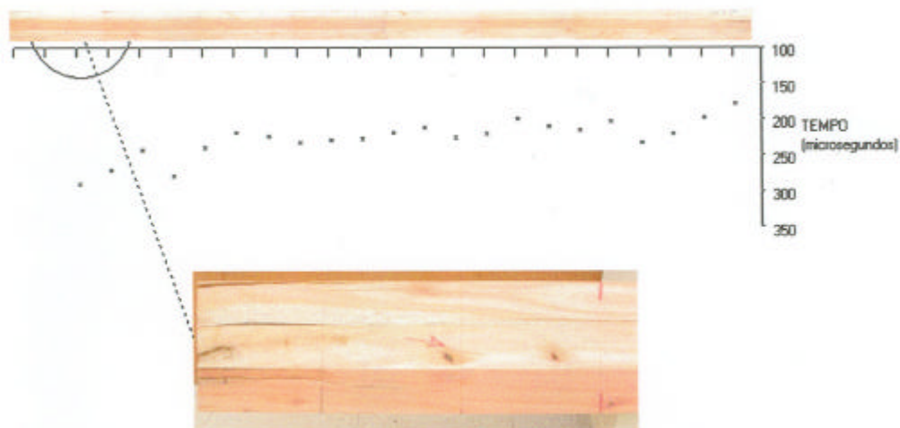
Figura 32 – Imagem de uma tábua inteira, com um diagrama mostrando os valores de tempo transcorrido na propagação da onda de tensão, e parte ampliada da imagem, mostrando os locais contendo defeitos.
