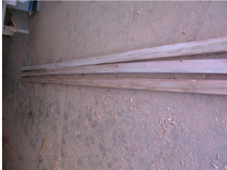
Figura 8 – Caibros de 8 cm, como aqueles utilizados na produção das tábuas, com empenamentos muito notáveis.
