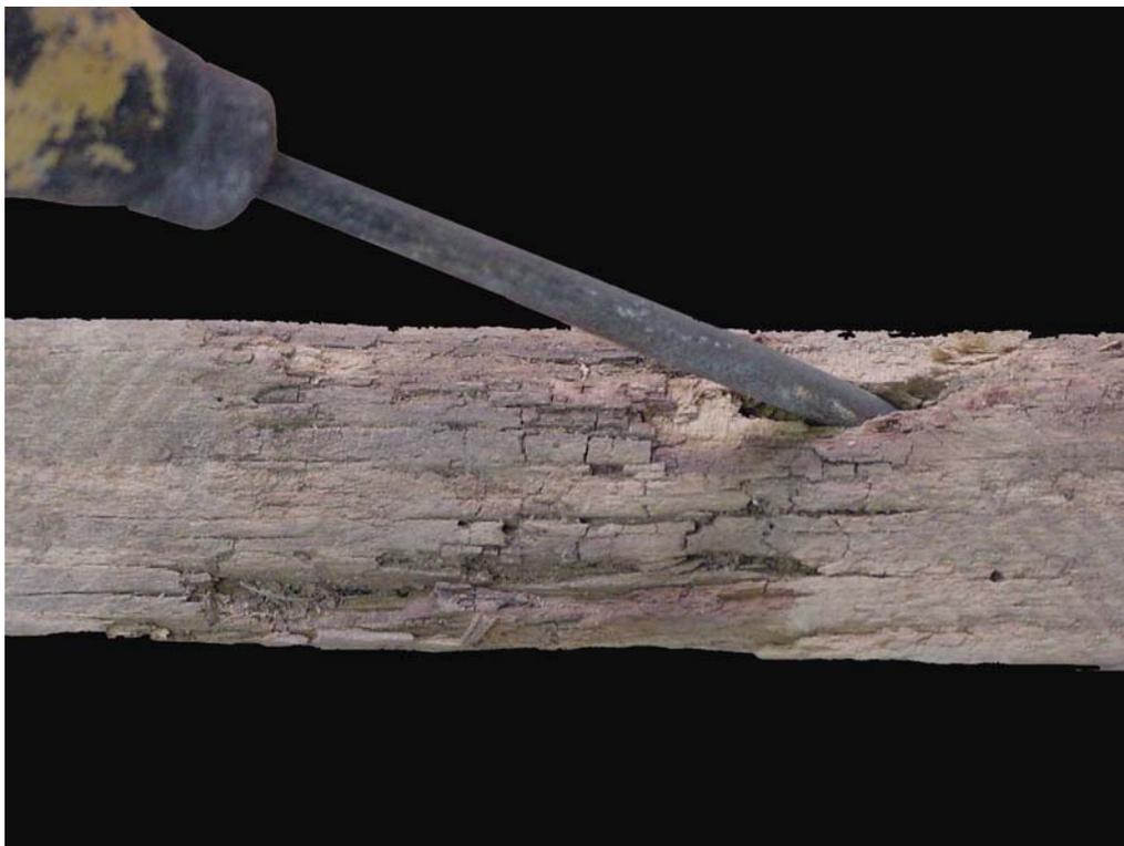
Figura 7 – Aspecto macroscópico de deterioração por fungo de podridão mole.
