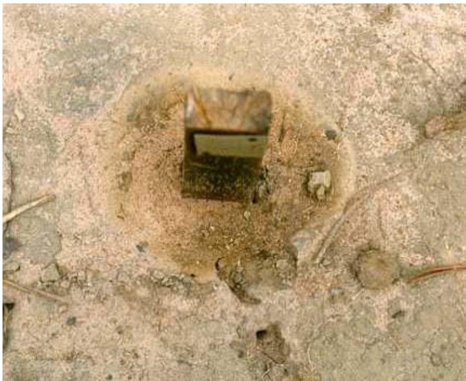
Figura 5 - Ilustrando o possível deslocamento do pentaclorofenol, da estaca para o solo.
