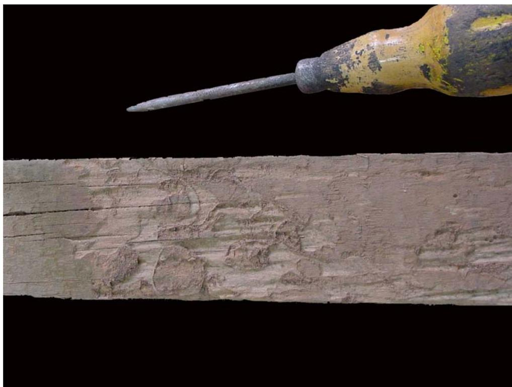
Figura 10 – Aspecto de estaca atacada por cupim subterrâneo.
