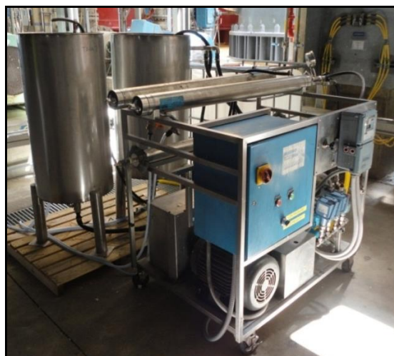
Figura 11 - Planta piloto de alimentação intermitente utilizada nas etapas 1 e 2
