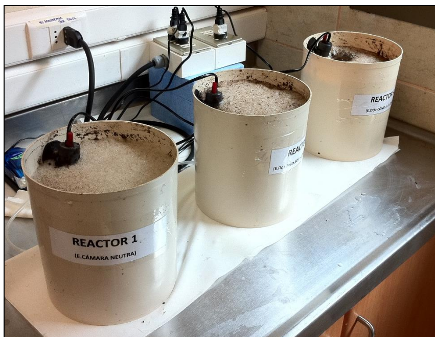
Figura 18 – Biorreatores em batelada de 3 litros com controle de temperatura e adição de oxigênio
