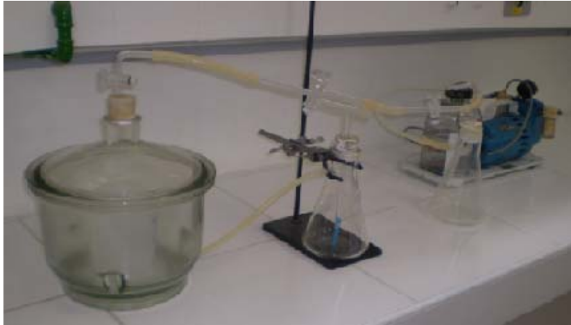
Figura 7 – Ilustração do sistema utilizado para impregnação das amostras de madeira
