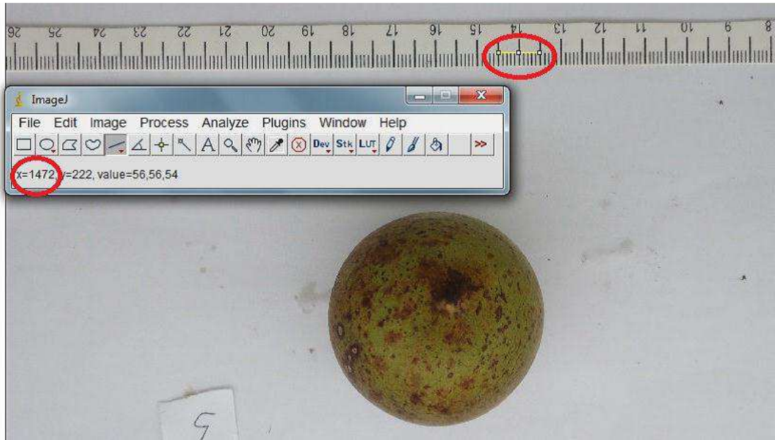
Figura 3. Calibração dimensional utilizando uma régua graduada e o Software ImageJ (FERREIRA e RASBAND, 2011) – determinação dos diâmetros em pixel e conversão para as medidas reais do fruto: quantidade de pixel por cm.
