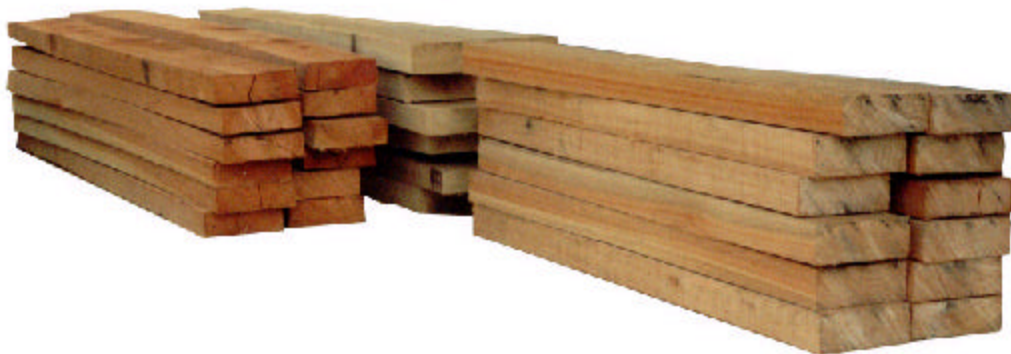
Figura 3 – Vigas de eucalipto amostradas para realização de ensaios físicos e mecânicos.
