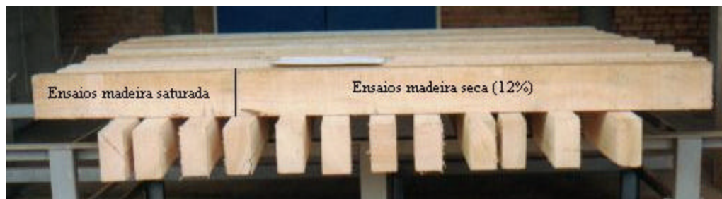
Figura 5 - Vigas identificadas para extração dos corpos de prova para ensaios com madeira saturada e madeira seca.
