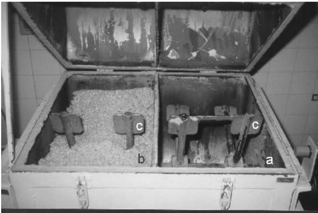
FIGURA 3. Encoladeira de laboratório aberta, mostrando o compartimento para encolagem (a) e o compartimento para desagregação de grumos (b). Ambos os compartimentos, dotados de pás para movimentação do material (c).
