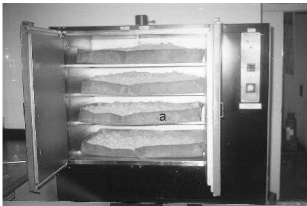
FIGURA 2. Estufa utilizada para secagem artificial das fibras dispostas em bandejas de tela metálica (a).
