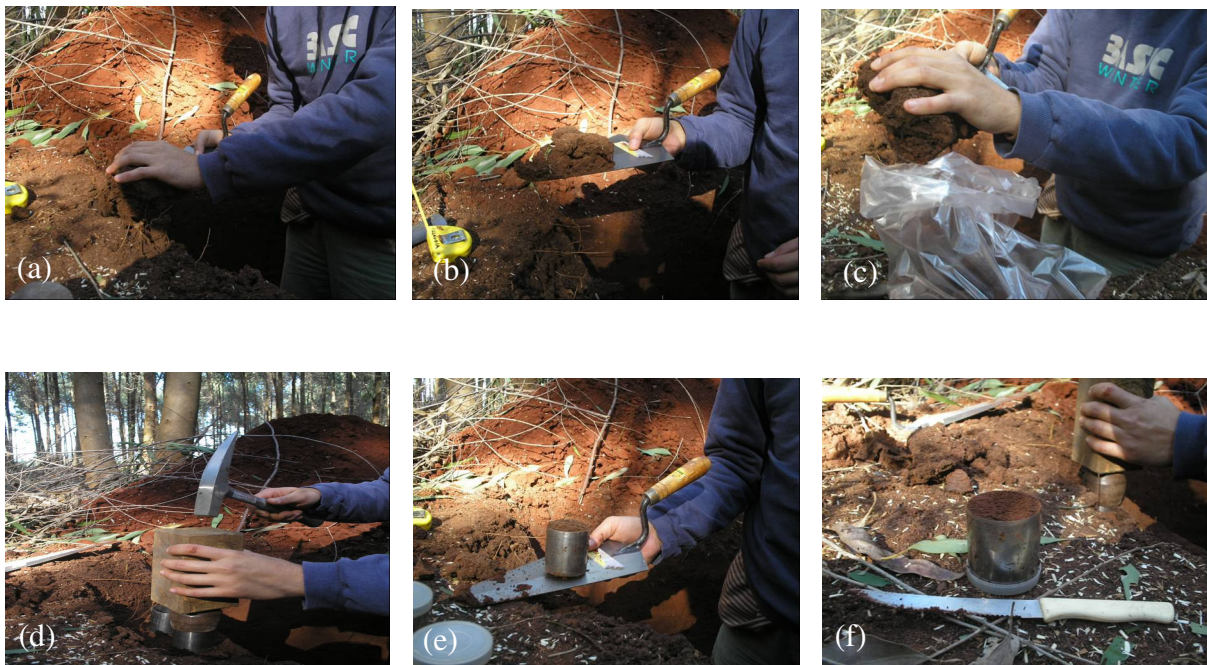
Figura 6 – Algumas das etapas da coleta de amostra com estrutura alterada (a, b, c) e preservada (d, e, f).
