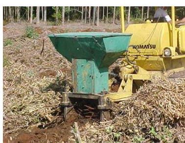
Figura 4 - Escarificador de três hastes utilizado no preparo do solo para implantação do eucalipto 4,5. Foto cedida gentilmente por Aracruz Celulose.
