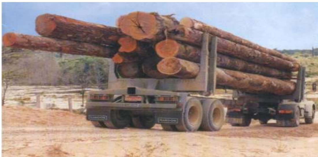
FIGURA 13 - CONJUGADO COMPOSTO: - CAVALO MECÂNICO E DOLLY COM CAMBÃO EXTENSÍVEL
