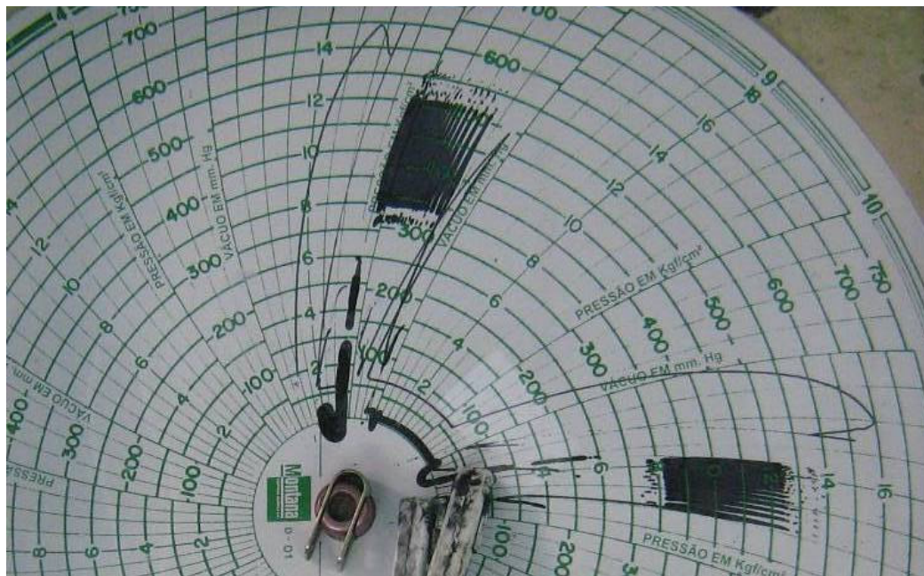
Figura 24 – Registro do tratamento preservativo em autoclave com CCA (Fonte: autor)
