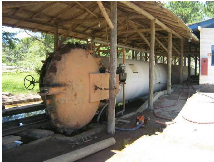
Figura 3 – Autoclave utilizada no tratamento industrial da madeira (Fonte: autor)
