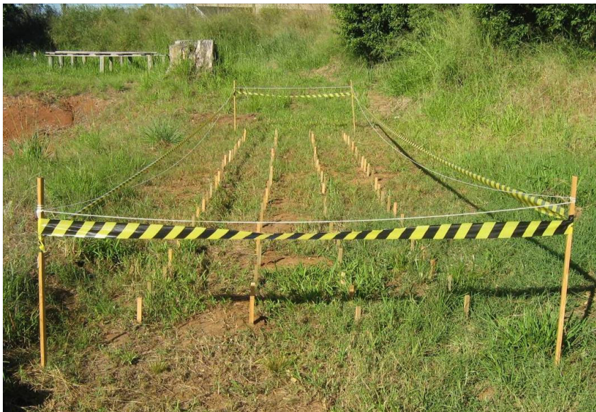
Figura 32 – Campo de apodrecimento instalado no campo aberto (Fonte: autor)
