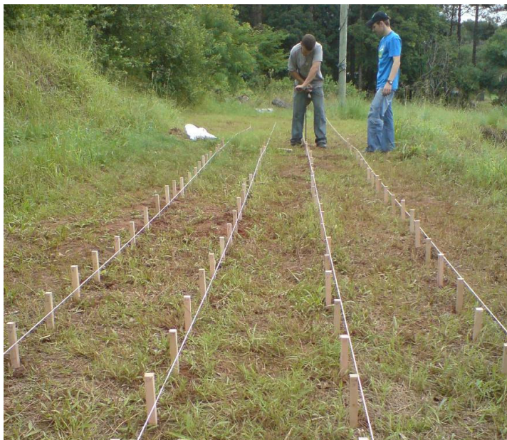
Figura 29 – Instalação do campo de apodrecimento em campo aberto (Fonte: autor)
