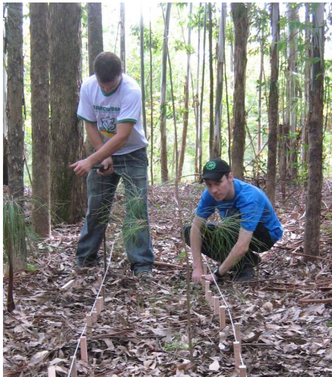
Figura 30 – Instalação do campo de apodrecimento em floresta (Fonte: autor)
