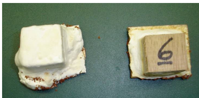
Figura 26 – Detalhe dos corpos de prova de Eucalyptus grandis removidos dos frascos junto com a placa suporte, à esquerda corpo de prova testemunha recoberto pelo micélio do fungo Trametes versicolor e a direita, corpo de prova tratado com CCA com pouco desenvolvimento do fungo Trametes versicolor (Fonte: LPF/SFB)
