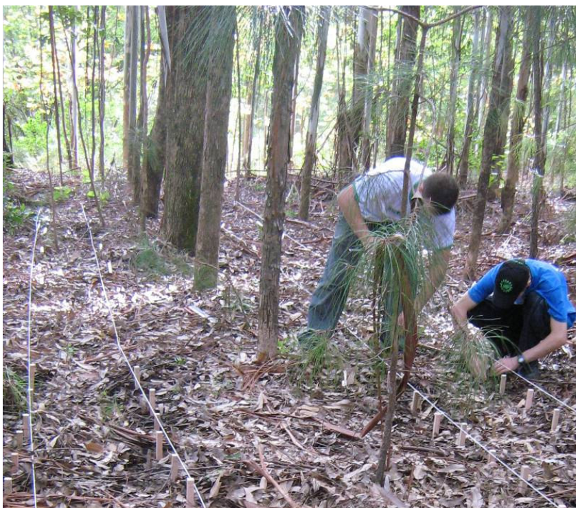
Figura 31 – Instalação do campo de apodrecimento em floresta (Fonte: autor)
