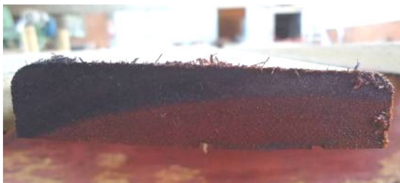
Figura 13 – Análise da penetração do CCA para a madeira de Eucalyptus cloeziana (Fonte: autor)
