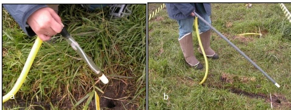
Figura 6.1 – a) Lisímetro posicionado a 30 cm de profundidade; b) Lisímetro posicionado a 80 cm de profundidade.
