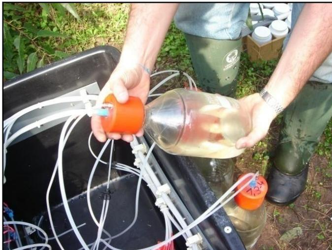
Figura 6.7 – Coleta de amostras da solução do solo armazenada nos coletores.
