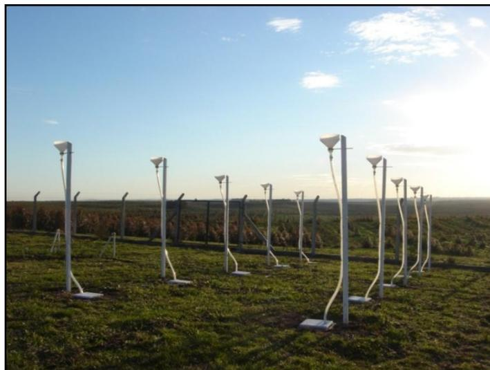
Figura 5.1 – Funis coletores de água da chuva, instalados na área de campo nativo.
