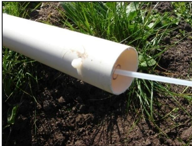
Figura 6.5 – Aspecto da mangueira com capilar no interior do tubo de PVC.
