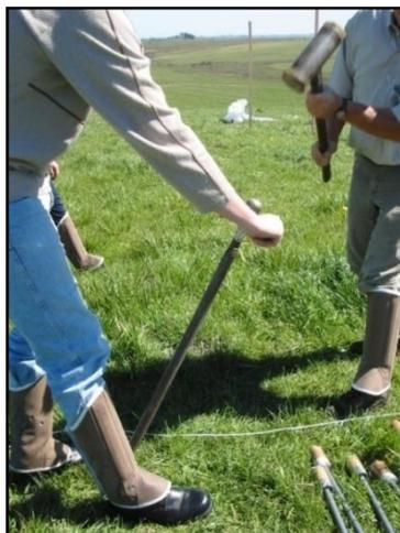
Figura 6.2 – Abertura dos orifícios para a colocação dos lisímetros.
