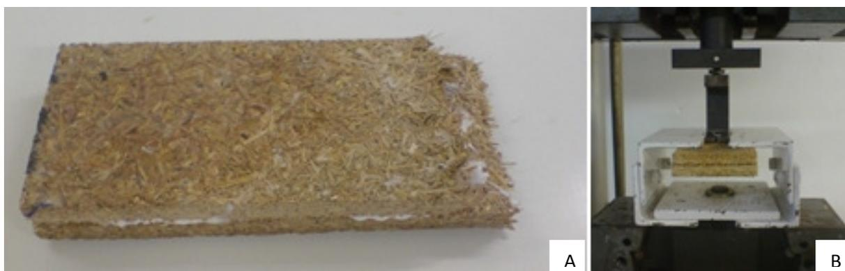
Figura 20 – (a) Amostra para o ensaio (b) Ensaio de arrancamento de parafuso
