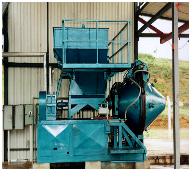
Figura 7. Reator piloto de pré-hidrólise ácida (ROMÃO, 2000)
