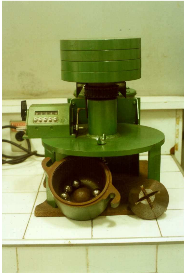
Figura 21. Equipamento utilizado no teste de moabilidade HGI - ASTM D-409 (2007).
