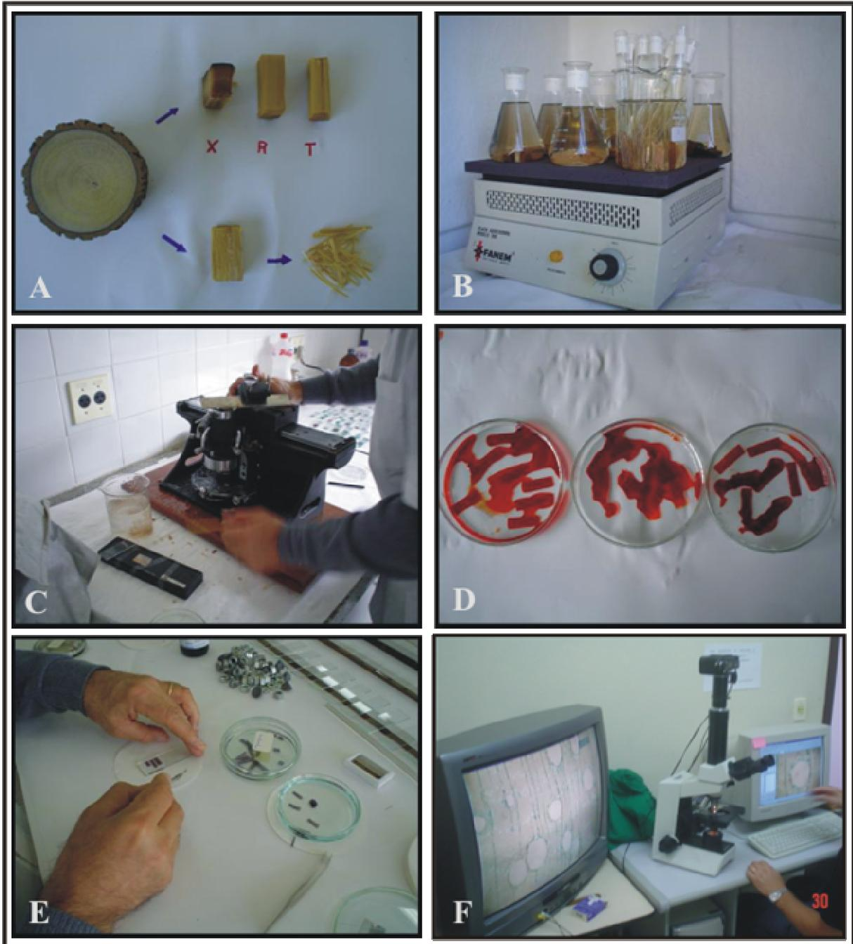
**Figura 1 – Etapas da metodologia usada no preparo das lâminas anatômicas.** A – Confecção dos corpos de prova (X: transversal, R: radial, T: tangencial); B – Fervura em água; C – Seccionamento em micrótomo de deslizamento; D – Coloração, desidratação e diafanização dos cortes anatômicos; E – Montagem das lâminas permanentes; F – Equipamento usado na obtenção de fotomicrografias das madeiras.
