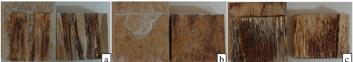
Figura 38 – Corpos de prova após o teste de cisalhamento a seco. Tratamento FV + E (a); tratamento FV + I (b); tratamento FF (c).
