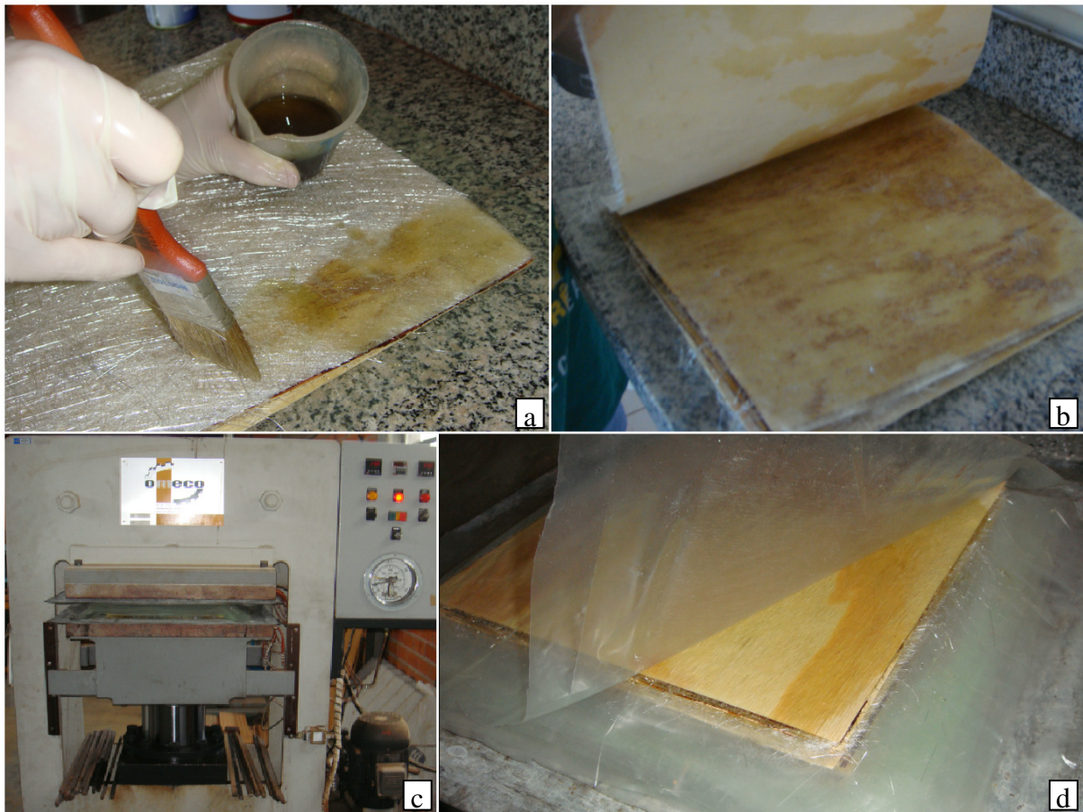
Figura 7 – Impregnação da fibra de vidro com resina isoftálica. Aplicação da resina sobre a fibra de vidro (a); fibra de vidro impregnada com a resina (b); prensagem dos painéis reforçados com fibra de vidro (c); painel após a prensagem (d).
