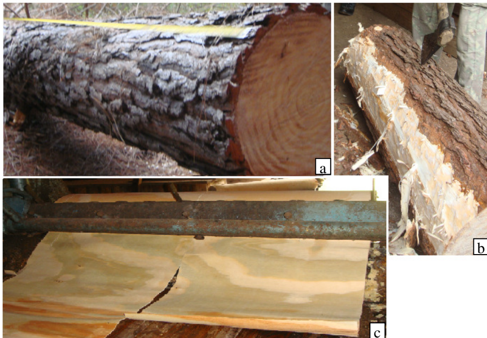
Figura 1 – Processo de laminação da madeira. Abate da árvore (a), descascamento (b) e desenrolamento (c).
