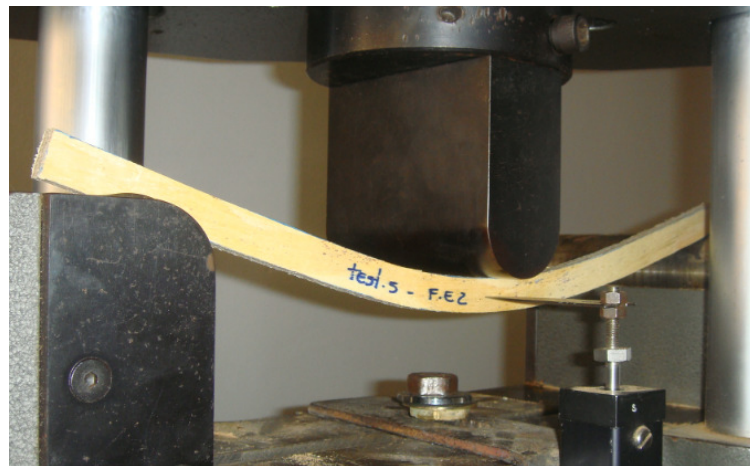
Figura 11 – Posicionamento do corpo de prova no ensaio de flexão estática na posição edgewise .
