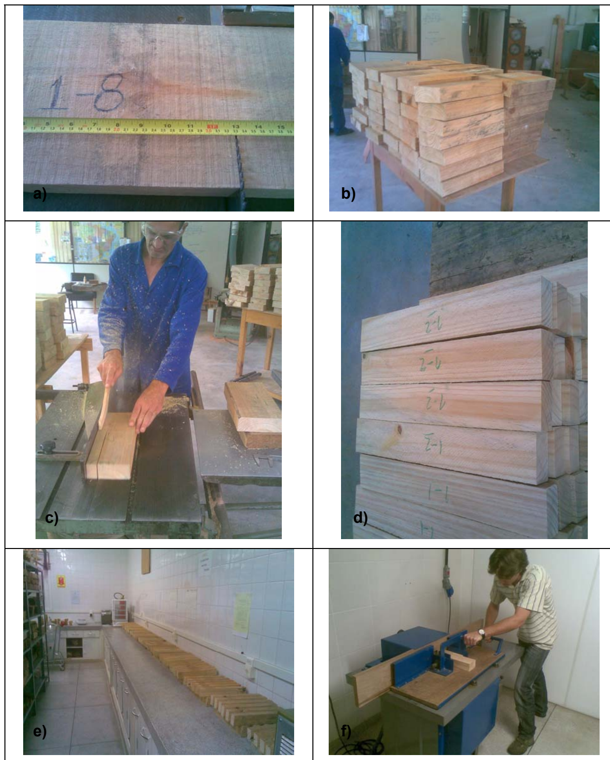
FIGURA 05 – Confeção dos sarrafos. a) Destopo dos pranchões; b) Blocos para desdobro dos sarrafos; c) Desdobro dos sarrafos; d) Sarrafos codificados em função das espécies; e) Sarrafos gradeados para climatização; f) Operação de ranhuras nos topos dos sarrafos.
