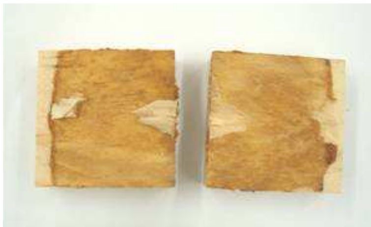
FIGURA 40. SUPERFÍCIE DO CORPO DE PROVA COM DESPRENDIMENTO NA MADEIRA.
