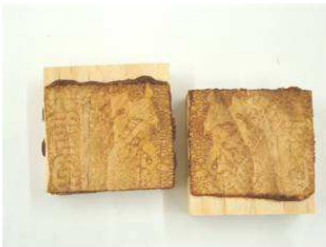
FIGURA 39 - SUPERFÍCIE DO CORPO DE PROVA SEM FALHA NA MADEIRA.
