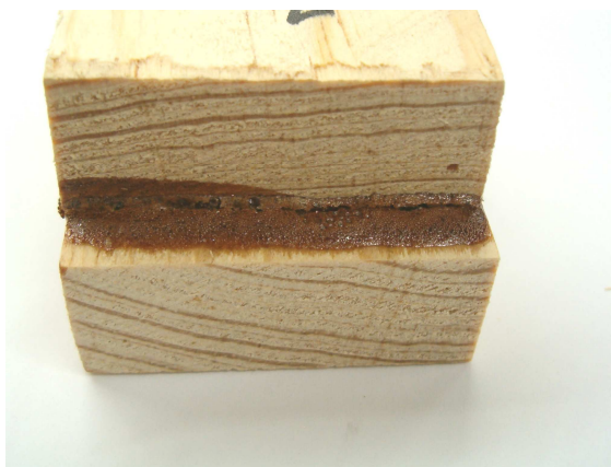
FIGURA 38 - FORMAÇÃO DE ESPUMA PELO EFEITO DA UMIDADE DO CORPO DE PROVA.
