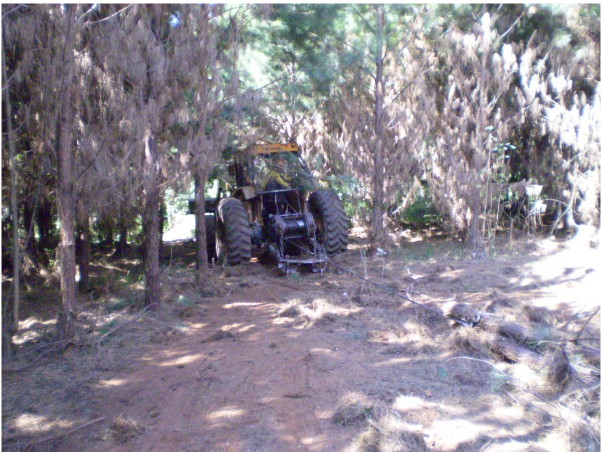
FIGURA 4.3 – Retirada das árvores por meio de trator com guincho.
