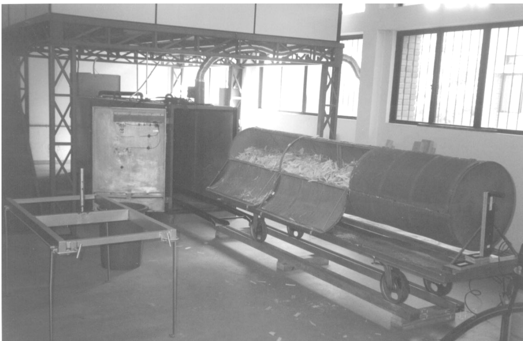
FIGURA 5 - APARATO UTILIZADO NA SECAGEM DAS PARTÍCULAS (PRIMEIRA ETAPA).
