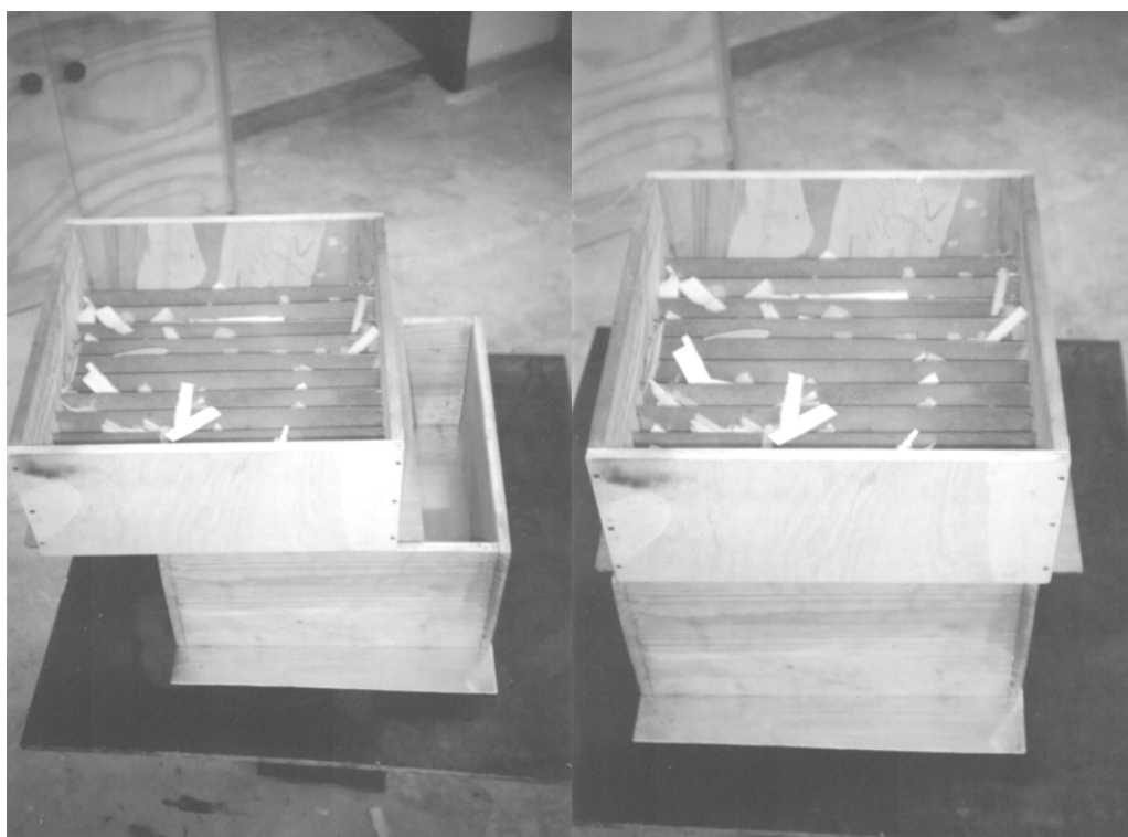
FIGURA 7 SISTEMA DE CAIXA ORIENTADORA DE PARTÍCULAS E CAIXA FORMADORA DO COLCHÃO.
