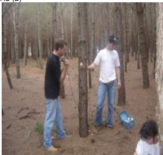
FIGURA 17 - MEDIÇÃO DA PROPAGAÇÃO DE ONDAS DE TENSÃO EM ÁRVORES EM PÉ (A) E EM TORAS (B)
