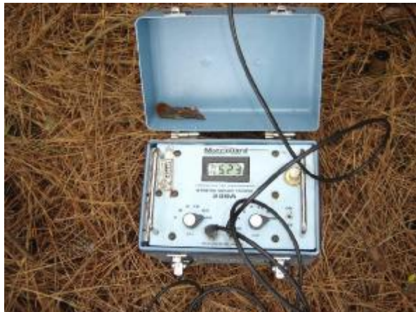
FIGURA 16 - APARELHO UTILIZADO PARA A MEDIÇÃO DO TEMPO DE PROPAGAÇÃO DE ONDAS DE TENSÃO
