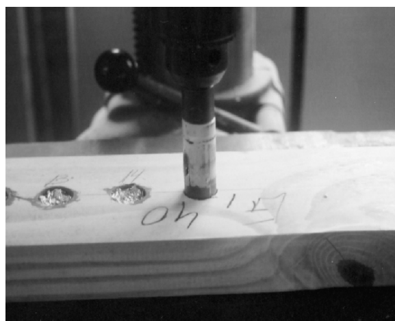
b. Corte do cilindro com serra de copo
