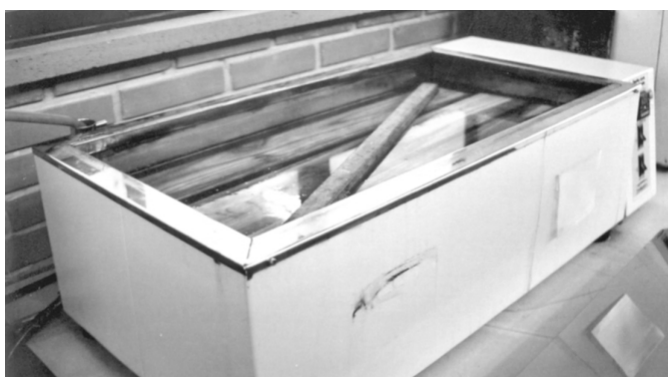
FIGURA 9 - AQUECIMENTO DAS AMOSTRAS CONTROLE À TEMPERATURA DE BULBO UMIDO EM BANHO MARIA
