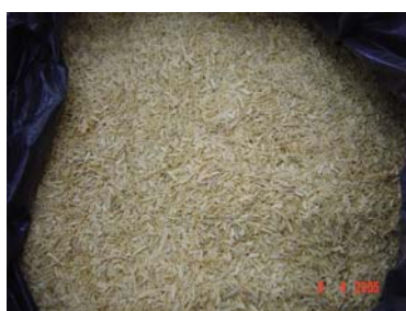
FOTO 11 PARTÍCULAS MOÍDAS E PENEIRADAS
