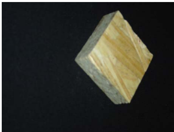
FOTO 14 – CORPO DE PROVA DO PAINEL OSB UTILIZADO NAS PAREDES DO PROTÓTIPO FONTE: DO AUTOR (2007)
