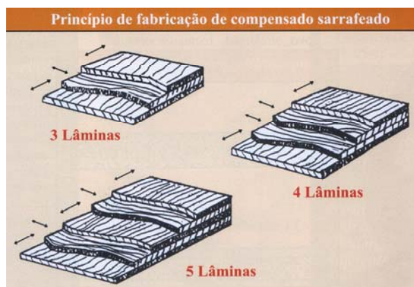
FIGURA 17 – ESQUEMA DE COMPOSIÇÃO DOS PAINÉIS COMPENSADOS MULTILAMINADOS FONTE: IWAKIRI (2003, P.5).
