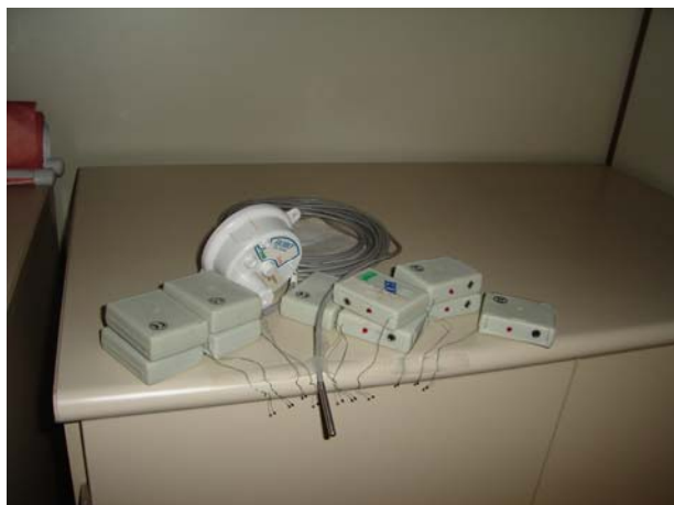
FOTO 28 – OS APARELHOS DE MEDIÇÃO – DATALOGGERS, FORAM DEIXADOS SOB CONDIÇÕES TÉRMICAS ESTÁVEIS (SEM VENTILAÇÃO, SEM GANHO SOLAR, AMBIENTE SEM VENTILAÇÃO OU CARGA TÉRMICA PARA CALIBRAÇÃO DOS DADOS.
