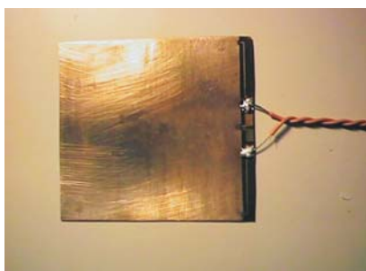
FOTO 29 – TRANSDUTOR DE FLUXO DE CALOR A GRADIENTE TANGENCIAL
