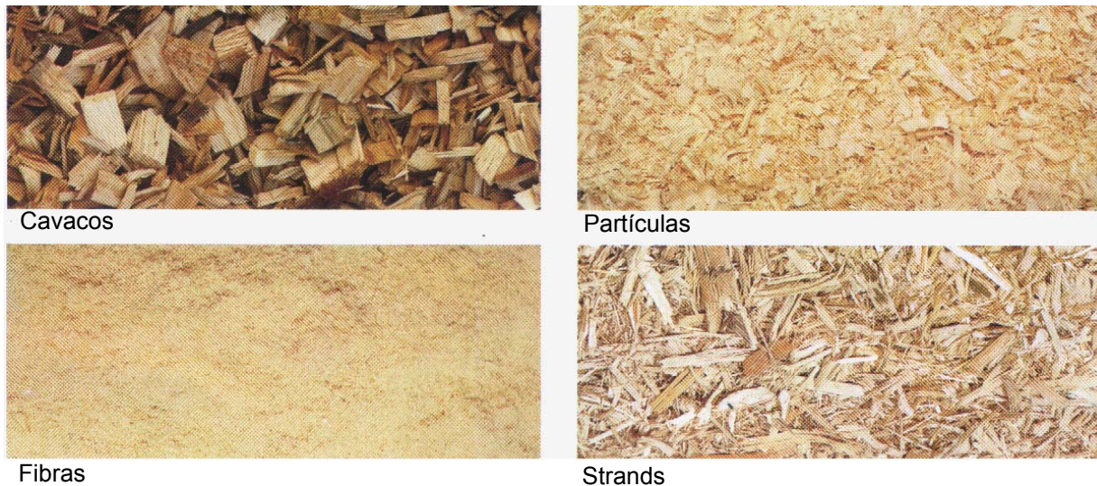
FIGURA 21 – MATÉRIAS-PRIMAS PARA OS PAINÉIS PARTICULADOS FONTE: CATÁLOGO DA EMPRESA SIEMPELKAMP – MDF PRODUCTION
