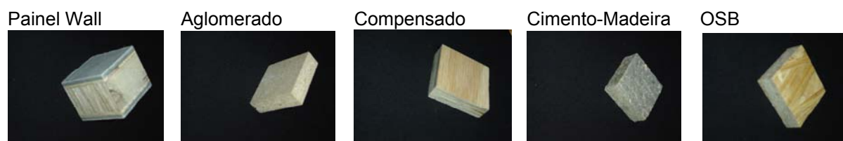
FOTO 15 – CORPOS DE PROVA 5,0 CM X 5,0 CM RETIRADOS DOS PAINÉIS ORIGINAIS FONTE: O AUTOR (2007)
