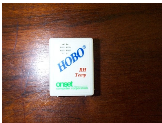
FOTO 25 - APARELHO DE MEDIÇÃO UTILIZADO TIPO HOBO, MODELO H08-003-02 FONTE: O AUTOR (2007)
