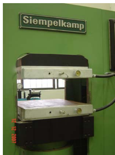
FOTO 12 – EQUIPAMENTO UTILIZADO PARA A Prensagem das placas de cimento- madeira – Prensa Siempelkamp – 40 kg/cm 2 , pertencente ao Laboratório de Tecnologia da Madeira da UFPR FONTE: O AUTOR (2007)
