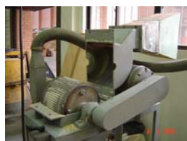
FOTO 9 - AS PENEIRAS SELECIONADAS INSTALADAS NO MOINHO DE MARTELO
