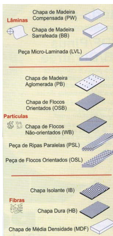
FIGURA 15 - FORMA DE APROVEITAMENTO DA MADEIRA PARA A FABRICAÇÃO DOS PAINÉIS LAMINADOS E PARTICULADOS FONTE: GONÇALVES ET AL. (2003, P.22)
