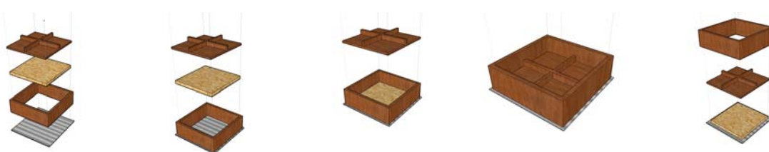
FIGURA 31 – CAIXA FORMADORA DO COLCHÃO – FORMA FONTE: O AUTOR (2007)
