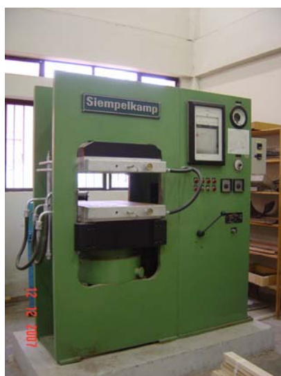
FOTO 12 – EQUIPAMENTO UTILIZADO PARA A Prensagem das placas de cimento- madeira – Prensa Siempelkamp – 40 kg/cm 2 , pertencente ao Laboratório de Tecnologia da Madeira da UFPR FONTE: O AUTOR (2007)
