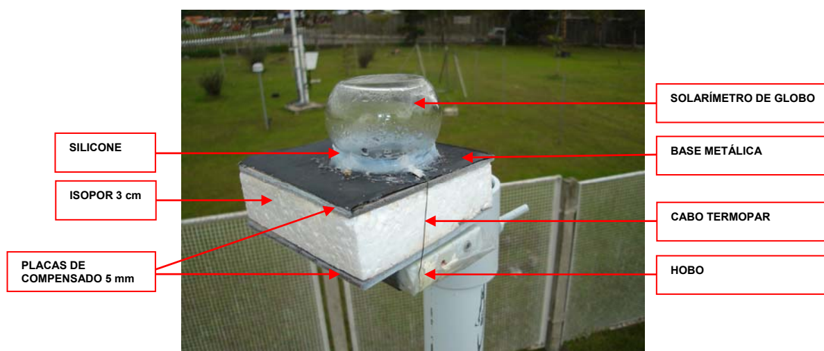
FOTO 32 – SOLARÍMETRO CONFECCIONADO COM GLOBO DE VIDRO FONTE: O AUTOR (2007)
