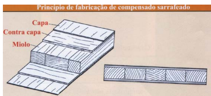
FIGURA 18 – ESQUEMA DE COMPOSIÇÃO DOS PAINÉIS COMPENSADOS SARRAFEADOS FONTE: IWAKIRI (2003, P.5)
