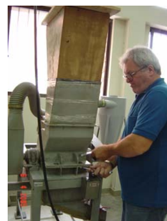
FOTO 10 - MOAGEM DAS PARTÍCULAS - PROCESSO REALIZADO TRÊS VEZES
