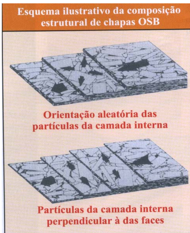
FIGURA 26 - PARTÍCULAS DE MADEIRA ORIENTADAS – OSB (ORIENTED STRAND BOARDS)
